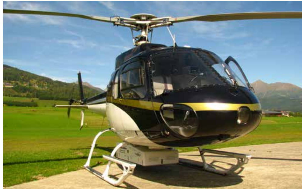
Der Laserscanner für die digitale Waldinventur wird an der Unterseite eines Hubschraubers montiert. Foto: Stefan Heinrich/Milan Geoservice GmbH
